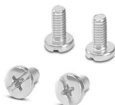
Vis de montage, jeu de 4, fixation de la carte de montage ou d'un circuit imprimé sur l'insert de montant, tête plate fente PH1, UNF 10-32 filetage fin, longueur : 10 mm, matériau : acier inoxydable
