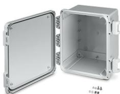
Boîtier pour applications extérieures, coloris : gris clair, dimensions : 12" x 10" x 6", avec inserts de montant, bouchon de couvercle, vis, couvercle : gris clair, fermeture rapide plastique, matériau : PC-UV stabilisé
