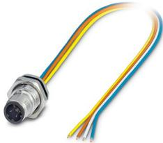
Connecteur d'appareil face arrière, PROFINET CAT5 (CEI 11801:2002), 4-pôles, Connecteur mâle, droit, M12-Standard, détrompage: D, sur extrémité libre, Montage face arrière, M16 x 1,5, Cordons individuels, longueur de câble: 0,5 m, 0,34 mm<sup>2</sup>, Cordon TPE, Produit de remplacement selon RoHS II sans exception 6c (Pb < 0,1 %) référence : 1238891
