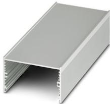
Boîtier pour profilé extrudé, Montage vissé, Capot profilé, coloris: couleurs aluminium, largeur: 75,6 mm, largeur du profilé (intérieure): 71,5 mm, largeur du profilé (extérieure): 75,6 mm, longueur: 200 mm, profondeur: 43,1 mm
