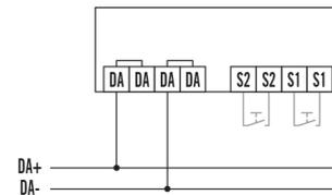
Raccordement avec commande optionnelle par poussoirs. Longueur de câble entre le poussoir et le détecteur : 30 m maximum
