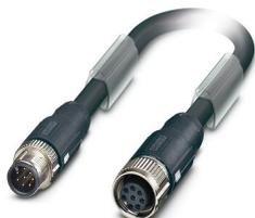
Câble préconfectionné pour bus, VARAN (100 Mbit/s), 6-pôles, blindé, connecteur mâle droit M12, détrompage: A, sur Connecteur femelle droit M12, détrompage: A, longueur de câble: 2 m
