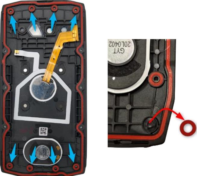
Le diagramme à gauche montre l'arrière d'un téléphone avec huit joints O-ring rouges indiqués par des flèches bleues. À droite, un gros plan illustre le processus de retrait d'un joint O-ring à l'aide d'une pince précelle, avec une flèche rouge pointant vers le joint et une autre vers la pince. | <p>Ces joints sont au nombre de 8. Ils sont collés et se retirent à l'aide d'une pince précelle.</p> |
