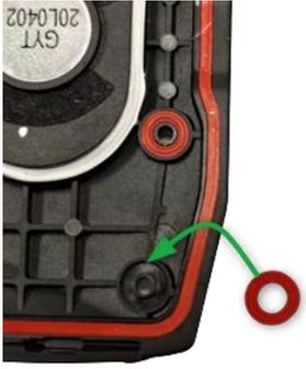
Le diagramme illustre le collage d'un joint O-ring rouge dans son emplacement sur l'arrière d'un téléphone, avec une flèche verte pointant vers le joint. | <p>Coller le joint O-ring dans son emplacement.</p> |
