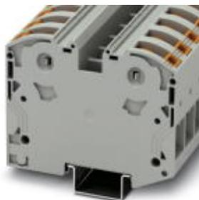
Bloc de jonction pour courant, Mode de raccordement: Raccordement Power-Turn, Nombre de connexions: 2, Section :2,5 mm<sup>2</sup> - 35 mm<sup>2</sup>, AWG: 12 - 2, Largeur: 16 mm, Coloris: gris, Type de montage: NS 35/15
