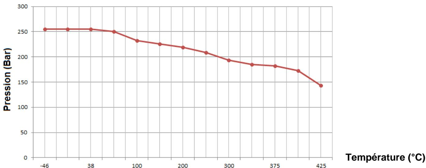
**ROBINET VANNE OPERCULE ACIER A350LF2 FORGE CLASS 1500 TRIM 12 FEMELLE NPT**
