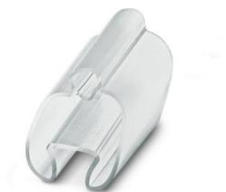
Repères pour fils, transparent, vierge, type de montage: enfilage, plage de diamètre de câble: 10 ... 14 mm, surface utile: 18 x 4 mm
