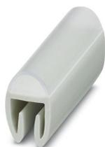
Repères pour fils, transparent, vierge, type de montage: clipsage, plage de diamètre de câble: 2 ... 3,5 mm, surface utile: 4 x 18 mm
