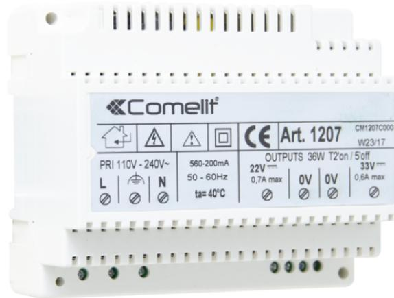
Alimentation avec protections contre les surcharges et les courts-circuits. 2 sorties distinctes en continu : une pour alimenter la platine extérieure et la gâche électrique 33Vcc et une pour alimenter le moniteur 20Vcc. Tensions d'entrée 230Vca. Dimensions 105x85x85 mm (6 modules DIN).
