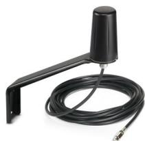
Antenne omnidirectionnelle multibande pour montage mural ou sur poteau, 0,6 GHz ... 6 GHz, gain : 3 dBi ... 7 dBi, indice de protection : IP66, raccordement : SMA (mâle), avec câble de raccordement de 5 m, étrier de montage et colliers pour poteaux
