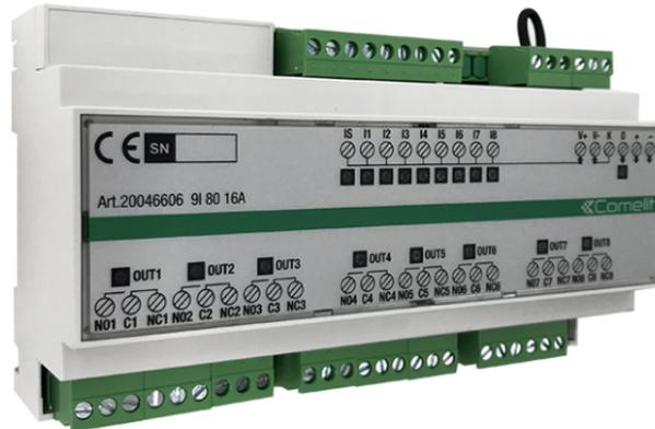
Module avec 9 entrées (8 + 1 scénario) pour relier les boutons au tableau électrique et de 8 sorties à relais avec contact en commutation NF/NO pour commander des charges électriques de type résistif jusqu'à 16A , dimensions : 160x90x58 mm (9 modules DIN). Consommation 220ma
