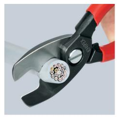
Coupe définitive : une fois la gaine du câble coupée dans le profil avant, on coupe les conducteurs dans le profil Coupe préliminaire : le fait d'utiliser le tranchant avant pour couper l'isolation de câbles plus épais permet de arrière. Coupe préliminaire à l'avant, coupe définitive à l'arrière – la coupe est plus facile.
