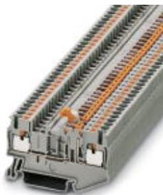
Bloc de jonction à couteau de sectionnement, Mode de raccordement: Raccordement Push-in, Section :0,14 mm<sup>2</sup> - 4 mm<sup>2</sup>, AWG: 26 - 12, Intensité nominale: 20 A, Tension nominale: 400 V, Longueur: 62 mm, Largeur: 5,2 mm, Coloris: orange, Montage: NS 35/7,5, NS 35/15
