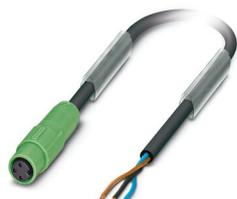
Câble pour capteurs/actionneurs, 3-pôles exempt d'halogène, extrémité libre, sur Connecteur femelle droit M8, détrompage: A Snap-in, longueur de câble: 0,6 m
