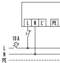
Raccordement avec commande optionnelle par poussoir.
