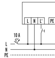
Raccordement standard avec fonction d'éclairage permanent commandée par interrupteur externe.
