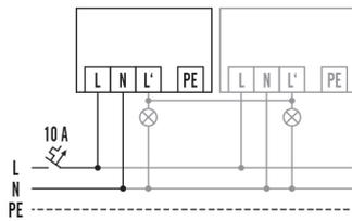
Raccordement optionnel de luminaires automatiques en parallèle
