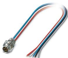
Embases paroi avant, DeviceNet™, 5-pôles, Connecteur mâle, droit, M8, Montage sur face avant, M8 x 0,5, Cordons individuels, longueur de câble: 0,5 m, 0,25 mm<sup>2</sup>, Cordon PVC
