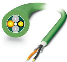
Câble d'installation PCF-PROFINET à confectionner (uniquement têtes IP20) pour le câblage dans des installations et machines fixes, éléments individuels en polyamide (PA), résistant à l'ozone et aux UV, avec gaine extérieure en PVC
