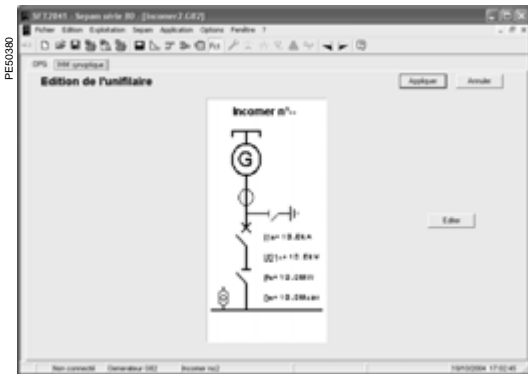
Accès à l'éditeur de synoptiques.
