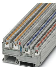
Bloc de jonction pour capteurs / actionneurs, avec voyant lumineux rouge, tension nominale: 250 V, intensité nominale: 13,5 A, nombre de connexions: 4, type de raccordement: Raccordement Push-in, Section de référence: 1,5 mm<sup>2</sup>, section : 0,14 mm<sup>2</sup> - 1,5 mm<sup>2</sup>, type de montage: NS 35/7,5, NS 35/15, coloris: gris
