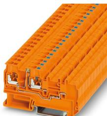
Bloc de jonction pour capteurs / actionneurs, Module d'alimentation, tension nominale: 24 V, intensité nominale: 13,5 A, nombre de connexions: 2, type de raccordement: Raccordement Push-in, Section de référence: 2,5 mm<sup>2</sup>, section : 0,2 mm<sup>2</sup> - 4 mm<sup>2</sup>, type de montage: NS 35/7,5, NS 35/15, coloris: orange
