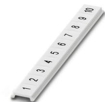
Ruban de repérage ZB, plat, Rubans, blanc, repéré, impression longitudinale: numérotation continue 1 ... 10, 11 ... 20, etc. jusqu'à 491 ... 500, type de montage: encliquetage, pour bloc de jonction au pas de : 5 mm, surface utile: 5,15 x 5,15 mm, Nombre d'étiquettes: 10
