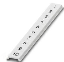
Ruban de repérage ZB, plat, Rubans, blanc, repéré, impression transversale: numérotation continue 1 ... 10, 11 ... 20, etc. jusqu'à 91 ... 100, type de montage: encliquetage, pour bloc de jonction au pas de : 5 mm, surface utile: 5,15 x 5,15 mm, Nombre d'étiquettes: 10
