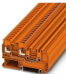
Bloc de jonction pour capteurs / actionneurs, Module d'alimentation, tension nominale: 250 V, intensité nominale: 20 A, nombre de connexions: 2, type de raccordement: Raccordement Push-in, Section de référence: 2,5 mm<sup>2</sup>, section : 0,2 mm<sup>2</sup> - 4 mm<sup>2</sup>, type de montage: NS 35/7,5, NS 35/15, coloris: orange
