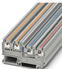
Bloc de jonction pour capteurs / actionneurs, avec voyant lumineux vert, tension nominale: 250 V, intensité nominale: 13,5 A, nombre de connexions: 4, type de raccordement: Raccordement Push-in, Section de référence: 1,5 mm<sup>2</sup>, section : 0,14 mm<sup>2</sup> - 1,5 mm<sup>2</sup>, type de montage: NS 35/7,5, NS 35/15, coloris: gris
