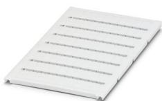
Repères pour blocs de jonction, Planche, blanc, vierge, repérable avec : BLUEMARK ID COLOR, BLUEMARK ID, BLUEMARK CLED, PLOTMARK, CMS-P1-PLOTTER, type de montage: encliquetage, pour bloc de jonction au pas de : 6,2 mm, surface utile: 5,6 x 10,5 mm, Nombre d'étiquettes: 80
