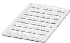
Repères pour blocs de jonction, à commander : sous forme de plaque, blanc, impression selon les indications du client, type de montage: encliquetage dans la rainure de repérage plate, pour bloc de jonction au pas de : 6,2 mm, surface utile: 5,6 x 5,1 mm, Nombre d'étiquettes: 80
