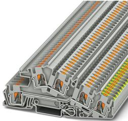
Bloc de jonction pour conducteur de protection d'installation, tension nominale: 400 V, intensité nominale: 28 A, Raccordement Push-in, 1., 2. und 3. Etage, Section de référence: 4 mm<sup>2</sup>, section : 0,2 mm<sup>2</sup> - 6 mm<sup>2</sup>, Raccordement Push-in, type de montage: NS 35/7,5, NS 35/15, coloris: gris
