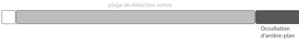
**Mode de fonctionnement fenêtre (deux points de commutation) :**
