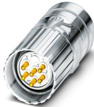
M23, Connecteurs à câble, série: CA, droit, blindé: oui, Verrouillage à vis, Nombre de pôles: 6, Sens de rotation: standard, type de contact: Mâle, Raccordement à sertir, plage de diamètre de câble: 10 mm ... 14,5 mm, détrompage: N, Produit de remplacement selon RoHS II sans exception 6c (Pb < 0,1 %) référence : 1243745
