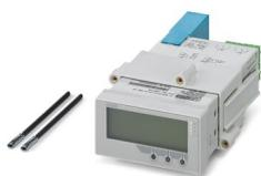
Ex i, Afficheur de process multifonction, intégré dans le boîtier du panneau de commande pour la surveillance et la représentation des valeurs de mesure analogiques. Les entrées universelles permettent de raccorder du courant, de la tension, des sondes de température (RTD) et des thermocouples (TC). 2 sorties de relais à inverseur et 1 sortie analogique.. HART
