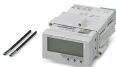
Afficheur de process multifonction, intégré dans le boîtier du panneau de commande pour la surveillance et la représentation des valeurs de mesure analogiques. Les entrées universelles permettent de raccorder du courant, de la tension, des sondes de température (RTD) et des thermocouples (TC). 2 sorties de relais à inverseur et 1 sortie analogique..
