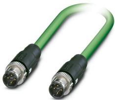
Câble de réseau, PROFINET CAT5 (100 Mbit/s), EtherCAT® CAT5 (100 Mbit/s), 4-pôles, Type de câble variable, blindé, connecteur mâle droit M12, détrompage: D SPEEDCONNEC / IP67, sur connecteur mâle droit M12, détrompage: D SPEEDCONNEC / IP67, longueur de câble: Longueur au choix (0,2... 40,0 m)
