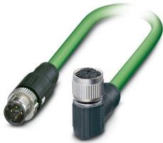
Câble de réseau, PROFINET CAT5 (100 Mbit/s), EtherCAT® CAT5 (100 Mbit/s), 4-pôles, Type de câble variable, blindé, connecteur mâle droit M12, détrompage: D SPEEDCONNEC / IP67, sur Connecteur femelle coudé M12, détrompage: D SPEEDCONNEC / IP67, longueur de câble: Longueur au choix (0,2... 40,0 m)
