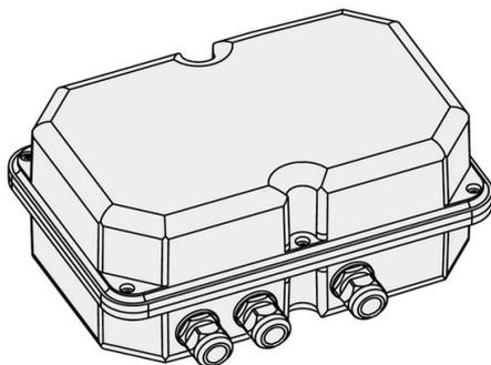
en nylon. Boîtier IP65 avec driver 24V - 100W pour LED 24 V. Avec interface gradable 1-10V / DALI et avec 4 serre-câbles diam. extérieur 9/12mm. Pour alimenter et grader 2 canaux 50W max pour un total de 100W.
