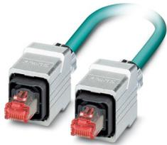
Câble Ethernet préconfectionné, blindé, à 4 paires, AWG 26 souple (7 fils), RAL 5021 (bleu d'eau), connecteur mâle RJ45/IP67 boîtier métallique Push-Pull sur connecteur mâle RJ45/IP67 boîtier métallique Push-Pull, Line, longueur 5 m
