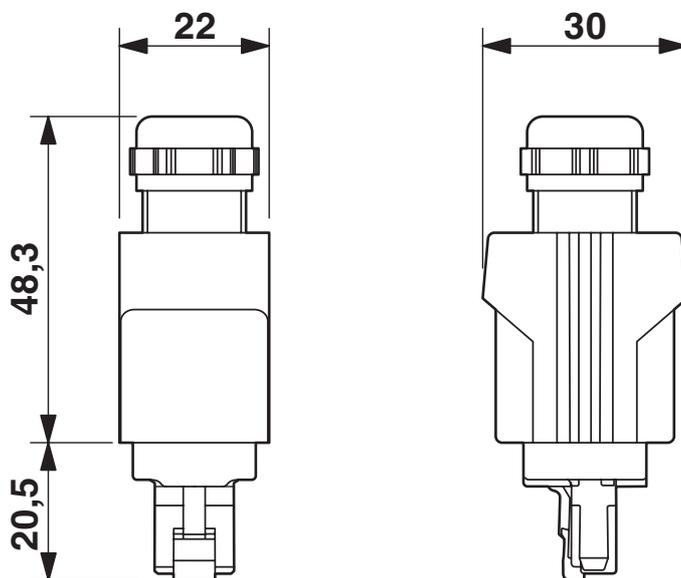
Connecteur mâle RJ45 Push-Pull, IP67
