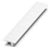
Repérage ZB, Rubans, blanc, vierge, repérable avec : CMS-P1-PLOTTER, PLOTMARK, Type de montage: Encliquetage dans la rainure de repérage élevée, pour bloc de jonction au pas de : 6,2 mm, Surface utile: 6,15 x 10,5 mm
