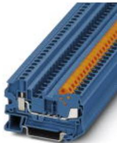
Blocs de jonction simple, type de raccordement: Raccordement rapide, Raccordement vissé, section: 0,5 mm<sup>2</sup> - 2,5 mm<sup>2</sup>, AWG: 20 - 14, largeur: 6,2 mm, coloris: bleu, montage: NS 35/7,5, NS 35/15
