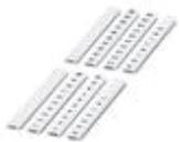
Repérage ZB, plat, Rubans, blanc, repéré, impression longitudinale: numérotation continue 1-10, 11-20, etc. jusqu'à 91-100, Type de montage: Encliquetage dans la rainure de repérage plate, pour bloc de jonction au pas de : 6,2 mm, Surface utile: 5,15 x 6,15 mm
