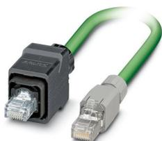
Câble PROFINET équipé, CAT5e, blindé, quarte en étoile, AWG 22 souple (7 fils), RAL 6018 (jaune-vert), connecteur RJ45/IP67 Push-Pull boîtier plastique sur connecteur RJ45/IP20, gris, Line, longueur : 5 m
