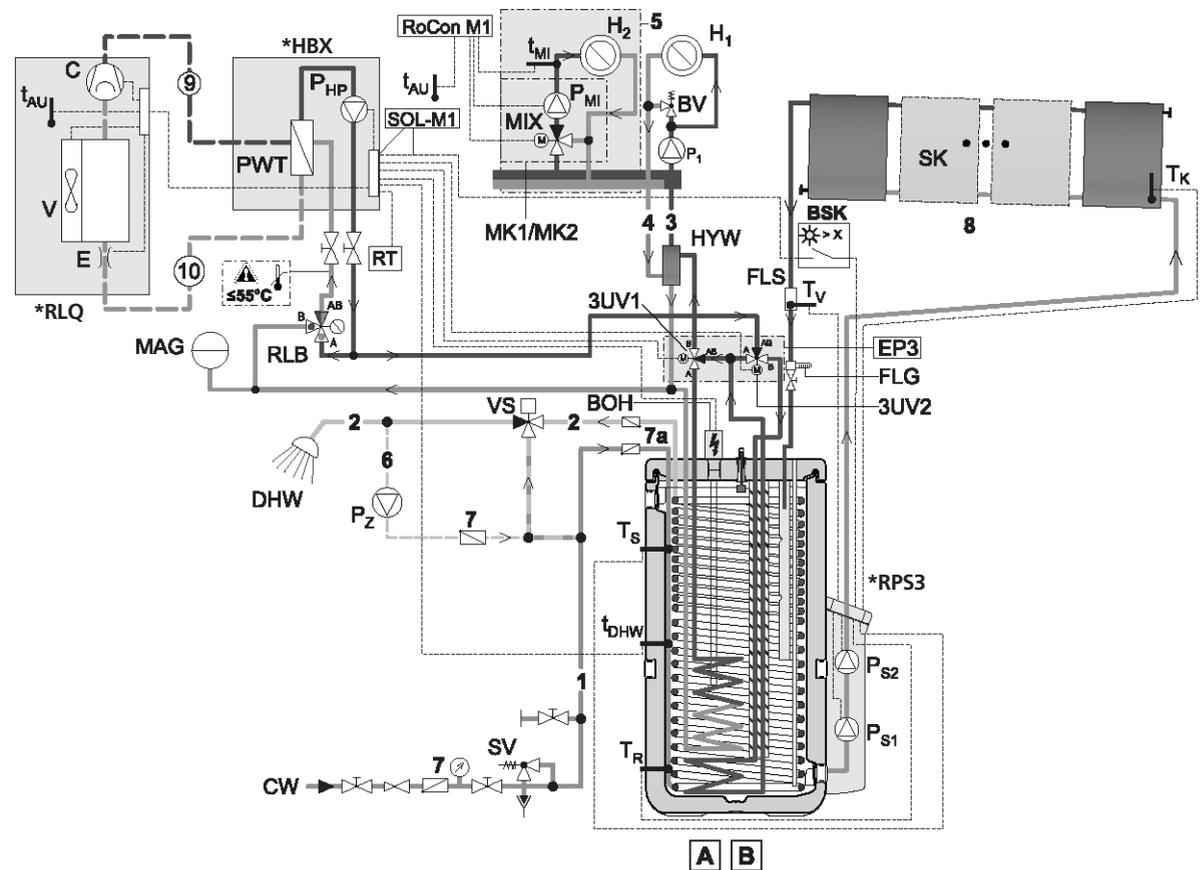
Configuration de connexion standard avec pompe à chaleur et système solaire à vidange autonome (Illustré dans la version avec fonction chauffage de l'air ambiant uniquement)
