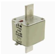
**Cartouche fusible, Basse tension, 315 A, AC 500 V, 120 kA, NH3, gL/gG, IEC, à double indicateur de fusion, pattes d'extraction conductrices**
