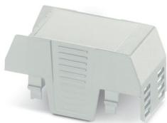
Boîtier électronique sur rail DIN, Partie supérieure du boîtier, design plat, ouverture de raccordement d'un côté, Ouverture de raccordement unilatérale, largeur: 35,1 mm, hauteur: 74,65 mm, profondeur: 36,95 mm, coloris: gris clair (7035)
