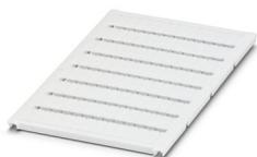
Repères pour blocs de jonction, à commander : sous forme de planche, blanc, impression selon les indications du client, type de montage: encliquetage dans la rainure de repérage élevée, pour bloc de jonction au pas de : 5,2 mm, surface utile: 10,5 x 4,6 mm, Nombre d'étiquettes: 96
