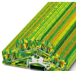
Bloc de jonction à deux étages, nombre de connexions: 8, type de raccordement: Raccordement Push-in, 1er et 2e étage, Section de référence: 2,5 mm<sup>2</sup>, section : 0,14 mm<sup>2</sup> - 4 mm<sup>2</sup>, type de montage: NS 35/7,5, NS 35/15, coloris: vert/jaune
