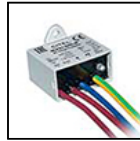
S.2498 DÉCHARGEUR DE SURTENSION 10kV CLASSE I Compatible avec tous les appareils d'éclairage en classe d'isolation CLASSE I Tension de fonctionnement 230-277V SPD type 2+3 Tension maximale de décharge 10kV Indice de protection IP67 IL FAUT PRÉVOIR POUR CHAQUE APPAREIL D'ÉCLAIRAGE UN DÉCHARGEUR DE SURTENSION; IL DOIT ÊTRE INSTALLÉ À UNE DISTANCE MAXIMALE DE 10m DE CE DERNIER.
