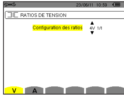
Figure 27 : l'écran Ratios de tension dans le menu Capteurs et ratios dans le cas d'un montage avec neutre
