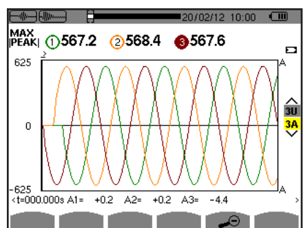
Figure 49 : l'écran d'affichage PEAK en 3A pour un branchement triphasé 3 fils
