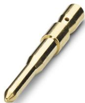
Contact à sertir, Tige, avancé, tournés, diamètre de contact: 1,5 mm, zone de sertissage: 0,5 mm<sup>2</sup> ... 1 mm<sup>2</sup>, Produit de remplacement selon RoHS II sans exception 6c (Pb < 0,1 %) référence : 1244974
