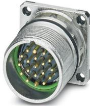
M23, Embases paroi avant, série: CA, droit, blindé: oui, Pour verrouillage standard et SPEEDCON, Nombre de pôles: 16+2+FE, Sens de rotation: standard, type de contact: Mâle, Raccordement à sertir, Joint plat, 4x Ø 3,2, cote de bride: 25 mm x 25 mm, détrompage: N
