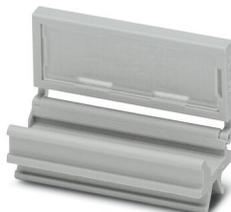
Etiquette de repérage de groupes de blocs de jonction, s'encliquette au centre des blocs de jonction à vis, à ressort ou à raccordement rapide, repérage avec ruban enfichable ESL 26 x 6 mm ou EST 25 x 6 mm, au niveau du pied avec un repérage ZB, longueur : 29 mm
