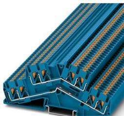
Bloc de jonction à deux étages, tension nominale: 800 V, intensité nominale: 20 A, type de raccordement: Raccordement Push-in, 1er et 2e étage, Section de référence: 2,5 mm<sup>2</sup>, section : 0,14 mm<sup>2</sup> - 4 mm<sup>2</sup>, type de montage: NS 35/7,5, NS 35/15, coloris: bleu
