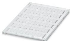
Repères pour blocs de jonction, Planche, blanc, vierge, repérable avec : TOPMARK NEO, LASER TOPMARK, BLUEMARK ID COLOR, BLUEMARK ID, BLUEMARK CLED, THERMOMARK PRIME, THERMOMARK CARD 2.0, THERMOMARK CARD, type de montage: encliquetage, pour bloc de jonction au pas de : 5,2 mm, surface utile: 4,6 x 10,5 mm, Nombre d'étiquettes: 72
