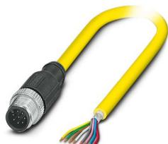
Câble pour capteurs/actionneurs, 8-pôles, PVC, jaune, blindé, connecteur mâle droit M12, détrompage: A, sur extrémité libre, longueur de câble: 10 m
