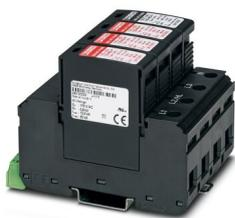
Parafoudre à 4 canaux avec contact de télésignalisation pour le couplage en étoile de 120/208 V triphasé AC, 4 fils plus la terre.
