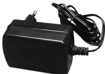
Alimentation 12V 1.5A sur **connecteur mâle** (2.1x5.5x12 ; intérieur positif, extérieur négatif) et prise européenne.
