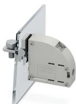
Bloc de jonction de traversée, type de raccordement: Raccordement vissé avec bague, Raccordement par cosse, nombre de pôles: 1, courant de charge: 150 A, enfichage du conducteur vers le sens d'enfichage: -90 °, largeur: 18,8 mm
