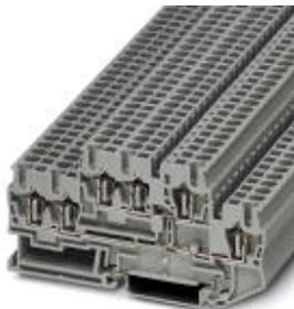
Bloc de jonction à ressort à 2 étages, Mode de raccordement: Raccordement à ressort, Section : 0,08 mm<sup>2</sup> - 4 mm<sup>2</sup>, AWG: 28 - 12, Largeur: 5,2 mm, Coloris: gris, Type de montage: NS 35/7,5, NS 35/15
