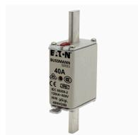
**Cartouche fusible, Basse tension, 40 A, AC 500 V, 120 kA, NH0, gL/gG, IEC, à double indicateur de fusion, pattes d'extraction conductrices**
