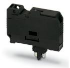
Fiche porte-fusible, Retirer la fiche porte-fusible du module de base avant de remplacer le fusible., tension nominale: 500 V, intensité nominale: 10 A, type de raccordement: Raccord enfichable, type de fusible: G /  $6.3 \times 32$ , coloris: noir
