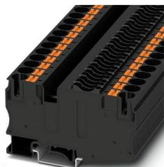
Bloc de jonction-fusibles, type de fusible: Plat, type de fusible: C, tension nominale: 400 V, intensité nominale: 25 A, type de raccordement: Raccordement Push-in, Section de référence: 10 mm<sup>2</sup>, section : 0,5 mm<sup>2</sup>- 16 mm<sup>2</sup>, type de montage: NS 35/7,5, NS 35/15, coloris: noir
