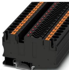
Bloc de jonction-fusibles, type de fusible: Plat, type de fusible: C, tension nominale: 48 V, intensité nominale: 25 A, type de raccordement: Raccordement Push-in, Section de référence: 10 mm<sup>2</sup>, section : 0,5 mm<sup>2</sup>- 16 mm<sup>2</sup>, type de montage: NS 35/7,5, NS 35/15, coloris: noir
