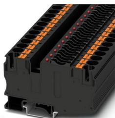
Bloc de jonction-fusibles, type de fusible: Plat, type de fusible: C, tension nominale: 24 V, intensité nominale: 25 A, type de raccordement: Raccordement Push-in, Section de référence: 10 mm<sup>2</sup>, section : 0,5 mm<sup>2</sup>- 16 mm<sup>2</sup>, type de montage: NS 35/7,5, NS 35/15, coloris: noir
