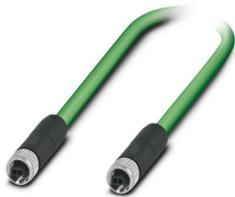
Câble de réseau, Single Pair Ethernet CAT B (1 Gbit/s), 2-pôles exempt d'halogène, blindé (Advanced Shielding Technology), Connecteur femelle droit M8-SPE / IP67, sur Connecteur femelle droit M8-SPE / IP67, longueur de câble: 2 m
