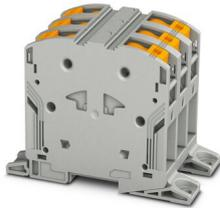
Bloc de jonction de puissance, bloqué, tension nominale: 1000 V, intensité nominale: 150 A, nombre de connexions: 6, nombre de pôles: 3, type de raccordement: Raccordement PowerTurn, 1er étage, section : 10 mm<sup>2</sup> - 70 mm<sup>2</sup>, type de montage: vissage direct, coloris: gris
