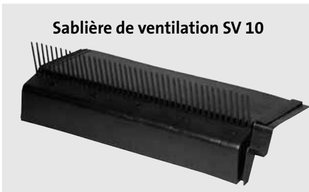
Elle permet la ventilation de chaque côté de l'**écran de sous-toiture** (V-TEX®, UBITEX®). Adaptée au toit en pente de 15° à 70°, elle s'installe sous l'écran de sous-toiture pour récupérer les condensations entre l'écran et la toiture. Elle se fixe avec des clous galvanisés de  $\varnothing$  3,35 mm et de 65 mm de long.
