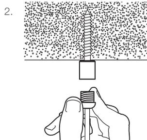
Étape 2 - Placer le système de suspension devant le trou percé
