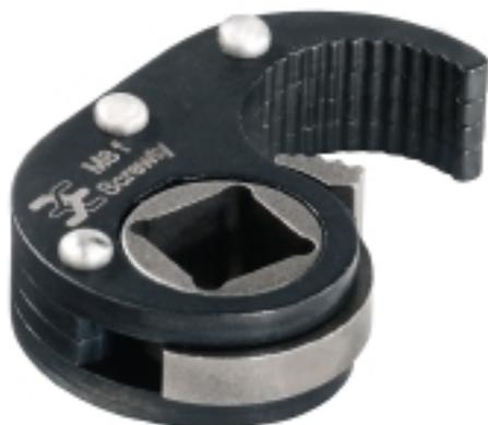
Les accessoires Screwty® sont indiqués pour les connecteurs débrochables ronds M8 à équiper, avec une dimension extérieure du moletage de  $11,9 \pm 0,3$  mm. Le couple de raccordement est de 0,5-0,6 Nm.
